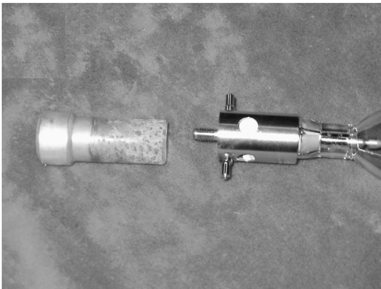
F32 – L'adattatore rimosso dalla lampada
